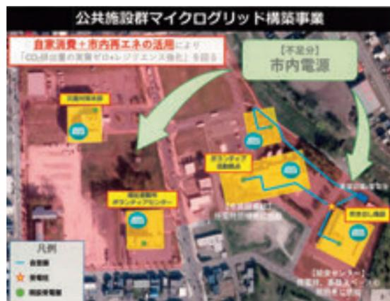
中心核エリアで計画するマイクログリッド構築の概念図
