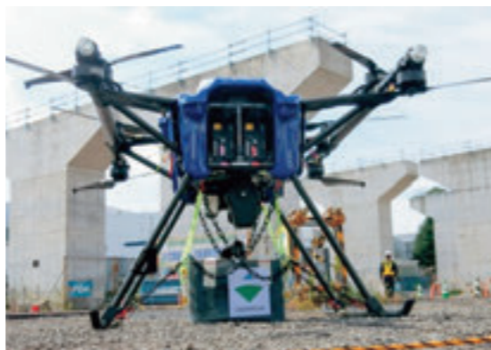
物流ドローン「スカイリフト」による資材運搬（大林組提供）
