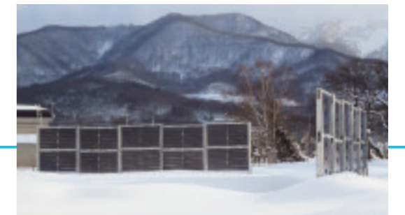
縦置き型パネルは、方角による日照の影響を検証するため2方向に設置
